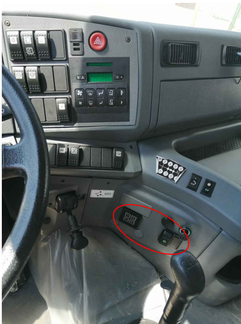
Рис.1 Общий вид системы управления двигателем автобетоносмесителя с обстановкой.
